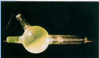
1905: Die emittierten Röntgenstrahlen lassen das Glas der 3-Elektroden-Ionen-Röhre grün fluoreszieren. Die Abstrahlung ist in Form einer Halbkugel sichtbar.
